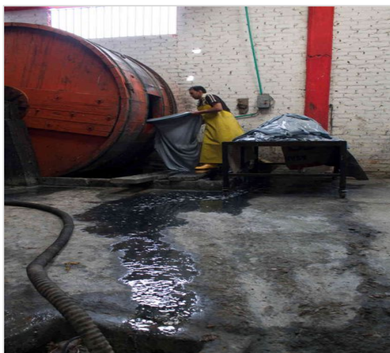
Lavagem de pele em curtume Fonte: Los trabajadores del cuero que le apuestan al resurgir del río Bogotá (Barros, 2018)
